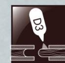
**Гибкая укладка с приклеиванием только гребня и паза.**
